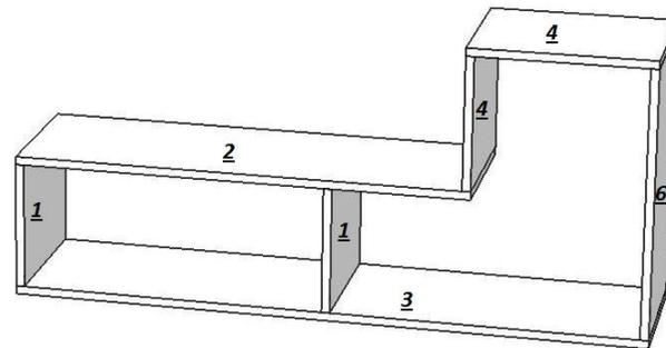
войлочная опора клеится в местах сопряжения с полом в зависимости как будет стоять конструкция
